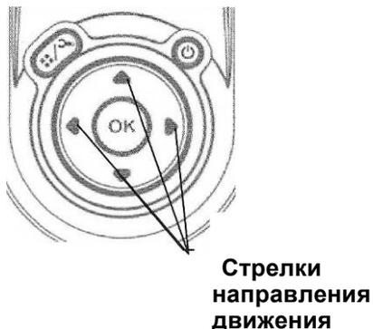
2. Для ручного управления используй стрелки направления движения.
